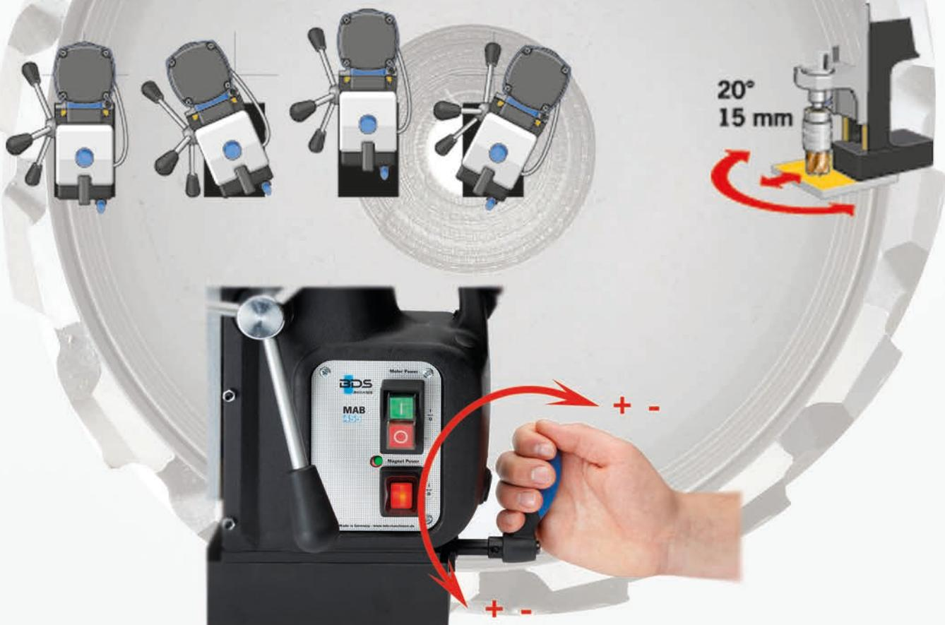
Zum verstellen der Maschine bei aktivierter Magnetfunktion lösen Sie den Klemmhebel und bringen den Bohrer in die gewünschte Bohrposition. Nachdem die Maschine positioniert wurde betätigen Sie die Klemmung in die entgegengesetzte Richtung.
