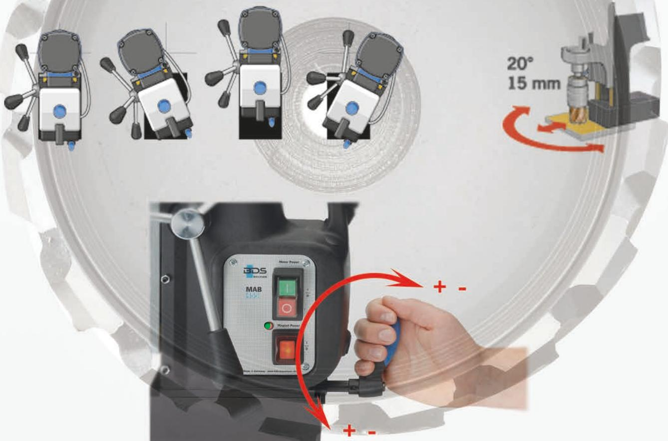
Для позиционирования сверлильного станка при включенном магните, поверните ручку поворотного устройства станка и освободите зажим. После того как станок позиционирован, поверните ручку зажима с усилием руки в противоположном направлении. Пожалуйста, обратите внимание:
